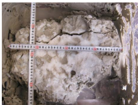
図 3 グラウト材固結物の一例の様子
