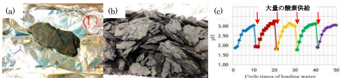
図2 (a)風化前の廃石、(b)風化後の廃石、(c)カラム試験における pH 変化
