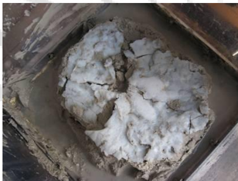
図1 グラウト材固結物の様子
